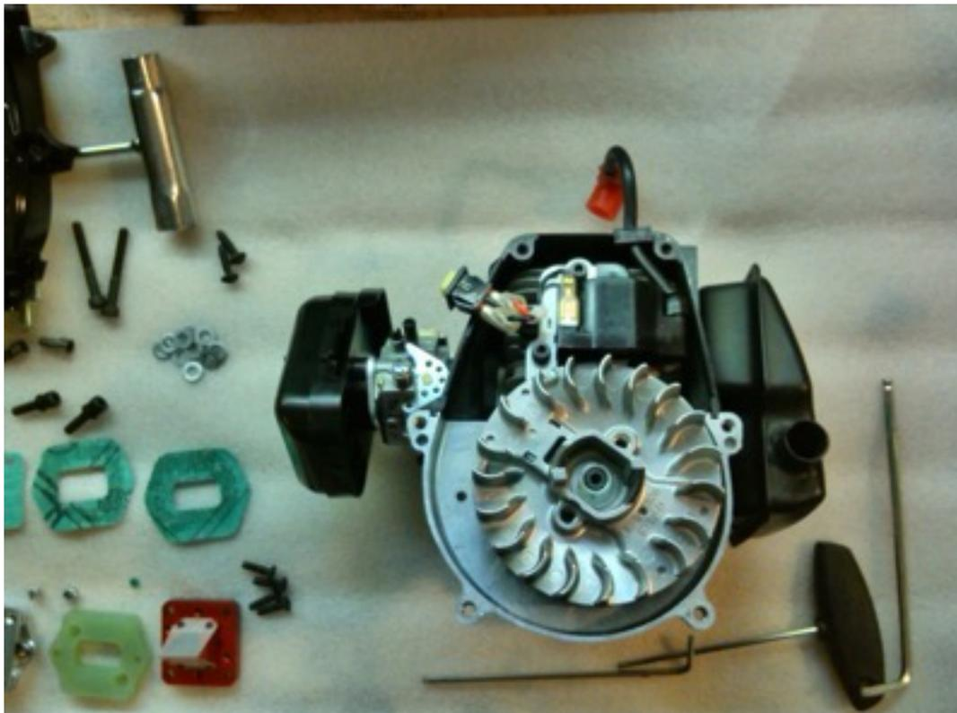
3. Nun werden die 4 Zylinderkopf Schrauben gelöst und der Zylinder abgenommen. Anschließend wird der Kolbenbolzensicherungs-Clip kupplungsseitig entfernt, der Kolbenbolzen herausgeschoben und die Anlaufscheiben zusammen mit dem Nadellager rausgenommen.
