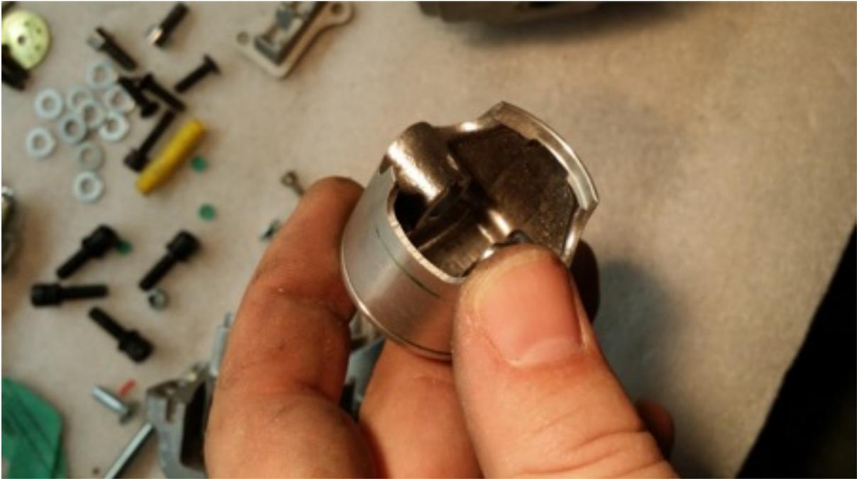
Ist dieser Arbeitsschritt abgeschlossen, müssen der Kolben gereinigt werden, so daß alle Späne entfernt sind. Anschließend kann der Kolben wieder installiert werden.
