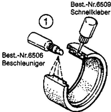
Reifeneinlage vor dem Zusammenkleben über die Felge legen und die Länge prüfen, ggf. kürzen. Reifeneinlage breit / schmal auf Stoß zusammenkleben. Eine Seite mit 6506 Beschleuniger besprühen. Auf die andere Seite Schnellkleber auftragen. Die beiden Enden der Reifeneinlage können auch anstatt des Schnellklebers mit Kontaktkleber zusammengeklebt werden. Beide Teile zusammendrücken.
