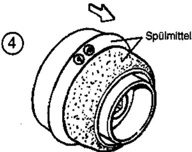
Reifen auf der gekennzeichneten Seite mit einem handelsüblichen Spülmittel bestreichen und über die Einlage, die fest mit der Felge verklebt ist, schieben. Spülmittelreste mit einem Tuch trockenwischen.
