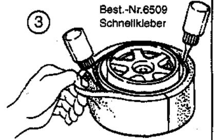
Reifeneinlage mit Schnellkleber vollflächig mit der Felge verkleben. Wichtig ist auch das Verkleben der Ränder, da diese sich sonst beim Aufziehen des Reifens lösen können.
