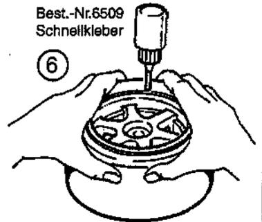
Bei Reifen die an der zu klebenden Stelle auf der Felge vollflächig anliegen, muß der Reifen leicht angehoben werden, so daß der Schnellkleber zwischen Reifen und Felge einfließen kann.
