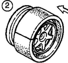
Reifeneinlage über die Felge ziehen und ausrichten.
