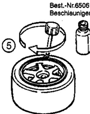
Reifen ausrichten und darauf achten, daß der Rand rundum exakt in der Nut sitzt, auf Rundlauf prüfen. Spalt zwischen Felge und Reifen mit Beschleuniger 6506 einstreichen.
