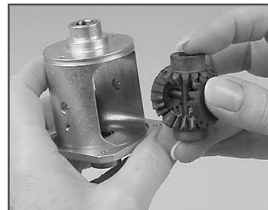
Bei Verwendung des FG Montagewerkzeuges Best.-Nr. 8505 wird das Einsetzen der Diff.-Kegelzahnräder bzw. des kompl. Paketes wesentlich erleichtert.
