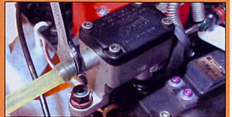
Die Ölwechselschrauben müssen um eine Drehung geöffnet werden.
